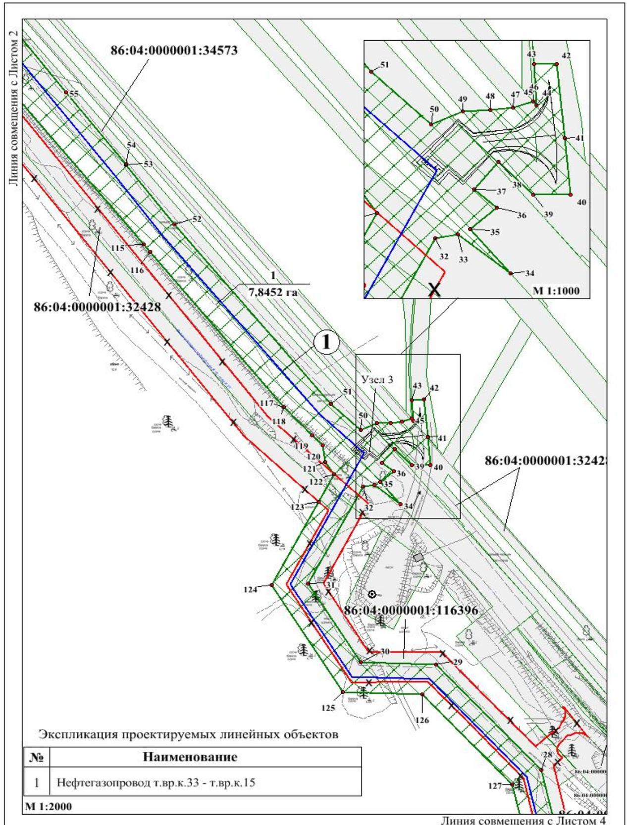
Чертеж границ зон планируемого размещения линейных объектов по объекту «Обустройство Северо-Покурского месторождения нефти. Нефтегазопроводы (1 очередь)»
