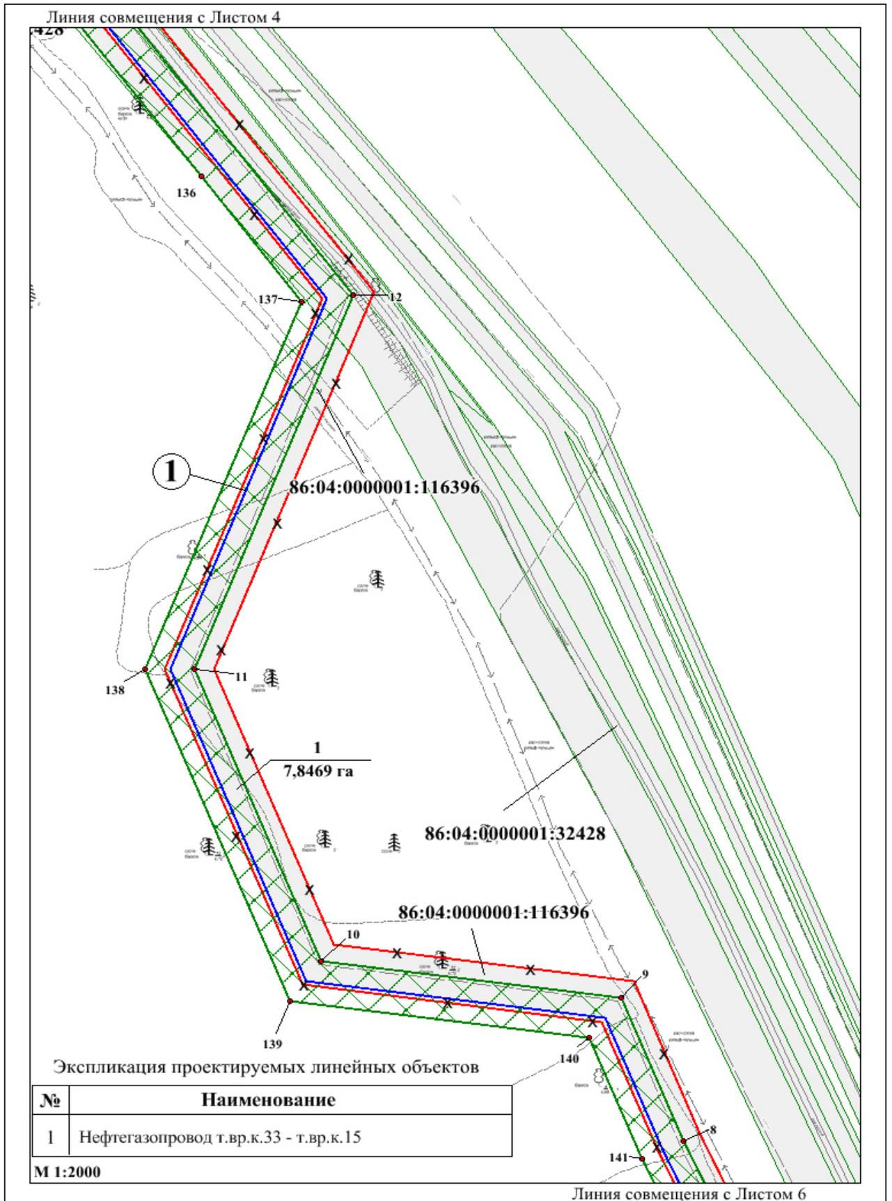
Чертеж границ зон планируемого размещения линейных объектов по объекту «Обустройство Северо-Покурского месторождения нефти. Нефтегазопроводы (1 очередь)»
